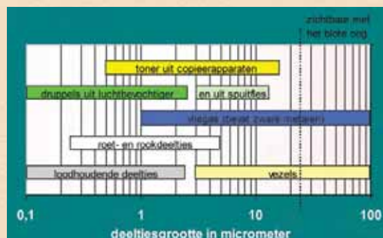
Deeltjesgrootte van mineraal stof in micrometers. De druppels van een luchtbevochtiger kunnen microben bevatten; die uit spuitflessen kunnen allergenen. De schaal is logaritmisch. Bijvoorbeeld: looddeeltjes zijn tussen 0,1 en 2,2 micrometer groot.
